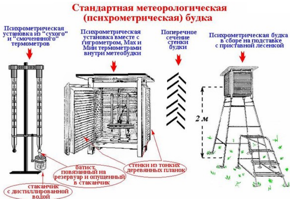
Рис. 3. Психрометрическая будка (общий вид)
